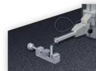
RUGOSURF 90G in modo di misura di profili con PROFILE SET 2 mm
